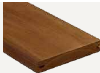
Kebony Clear Terrassendiele glatt, seitlich genutet und im Prinzip astfrei, ca. 2,2 cm stark, 14,2 cm breit. Längen: 3,00 - 4,80 m (auf Anfrage) (Art. Nr. 2131)
