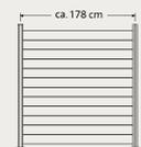
Grundpfosten aus Aluminium zum Einbetonieren oder zum Aufdübeln
