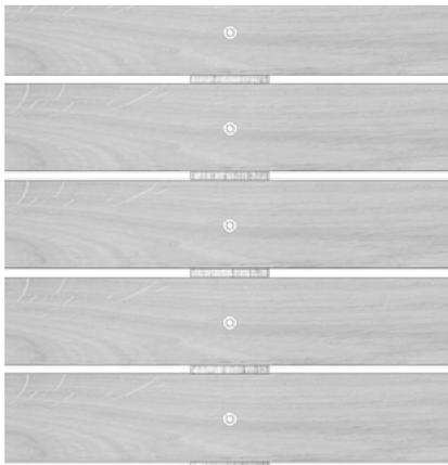
Bei Brettbreite  $\leq 70$  mm empfehlen wir eine Schraube zur Befestigung
